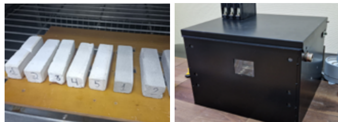
образцы akurit KIP и akurit KGN до испытаний
