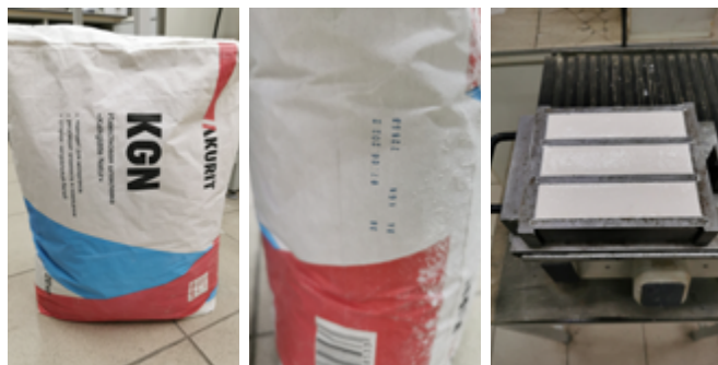
akurit KGN Известковая шпаклевка, изготовление образцов
