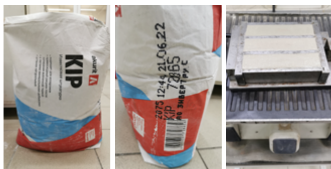
akurit KIP Известковая штукатурка, изготовление образцов
