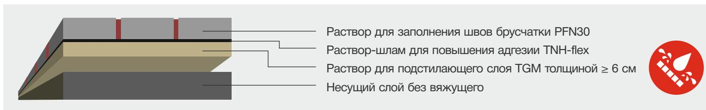
**Покрытие из керамической плитки или керамогранита с водонепроницаемыми швами.**
