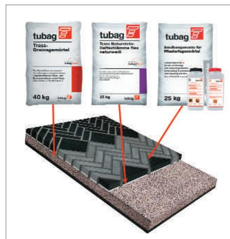
**Профессиональное заполнение швов.** Растворы для заполнения швов брусчатки в системы мощения *tubag* чрезвычайно просты в использовании: готовая смесь распределяется по чистой, предварительно увлажненной поверхности и утрамбовывается в швы с помощью резинового скребка. Прочность раствора на сжатие должна соотноситься с соответствующими показателями уложенного камня.
