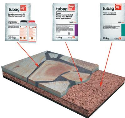
Водопроницаемые швы, укладка на готовое водопроницаемое основание
