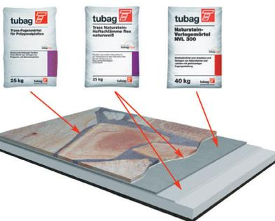
Водонепроницаемые швы, укладка на бетонное основание (по необходимости — гидроизоляция)
